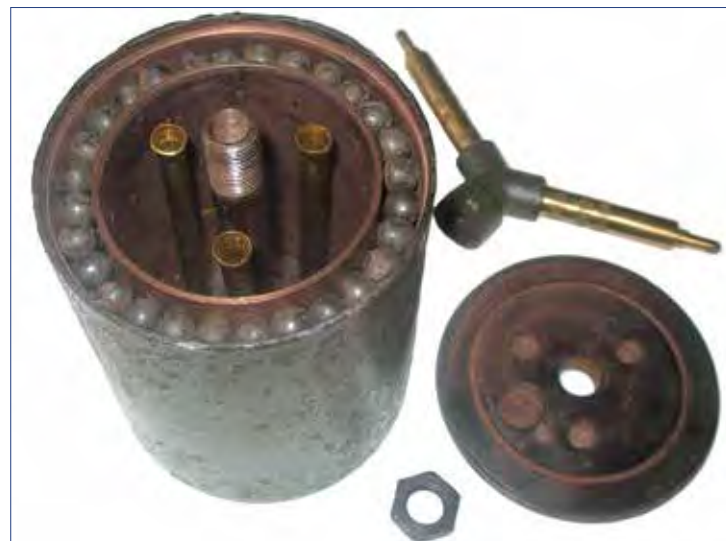
мина с тремя установленными взрывателями, одним нажимным и двумя натяжными
